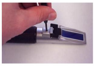
Подкрутите калибровочный винт до тех пор, пока граница между верхней синей областью и нижней белой областью не встретятся точно в нулевой отметке.
