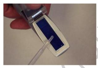
Начните калибровку рефрактометра, подняв пластинку для освещения дневным светом и помещая 2-3 капли дистиллированной воды на призме. Закройте пластинку так, чтобы вода распространилась по полной поверхности призмы без воздушных пузырьков и сухих мест.
